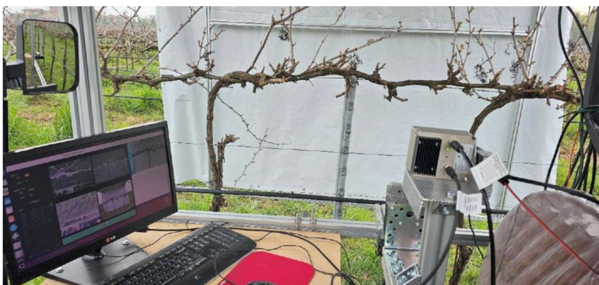
Postazione mobile di acquisizione installata sul Golf-Cart IRGC80. La struttura integra il tunnel di acquisizione, il sistema di elaborazione dati e gli strumenti di monitoraggio utilizzati per il controllo in tempo reale delle immagini e delle informazioni tridimensionali raccolte durante le prove in vigneto (Fonte foto: POTA.RATIO.)
