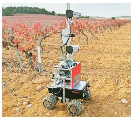
L'ora della vendemmia. Vinbot passa tra i filari e con la sua telecamera calcola la resa della vigna e la maturazione dell'uva
