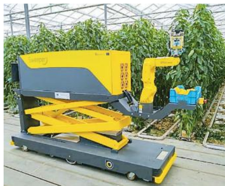
I peperoni. Sweeper è un robot creato con fondi europei. Riconosce i peperoni gialli, quando li incontra li raccoglie
