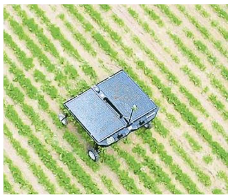
Fulminare le erbacce. Questo robot svizzero di Ecorobotix spruzza le infestanti con un erbicida. Robot simili le bruciano con un laser
