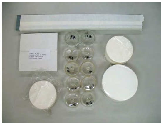
Fig. 7 Preparazione della determinazione del contenuto di umidità iniziale del substrato
