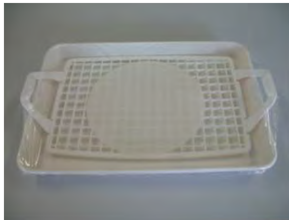
Fig. 14: Substrato posto sulla griglia per il drenaggio
