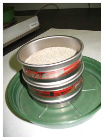
Fig. 24 Verifica della granulometria della sabbia
