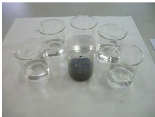
Fig. 4 Preparazione, 5 volumi di acqua con 1 volume di substrato
