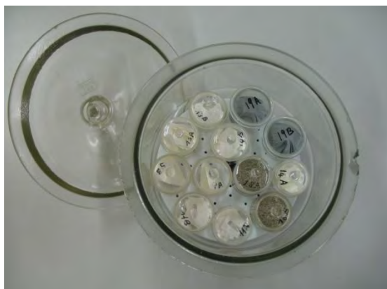
Fig. 11-12 Essiccatoio utilizzato durante la verifica dell'umidità iniziale del substrato
