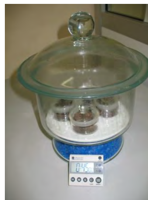
Fig. 11-12 Essiccatoio utilizzato durante la verifica dell'umidità iniziale del substrato
