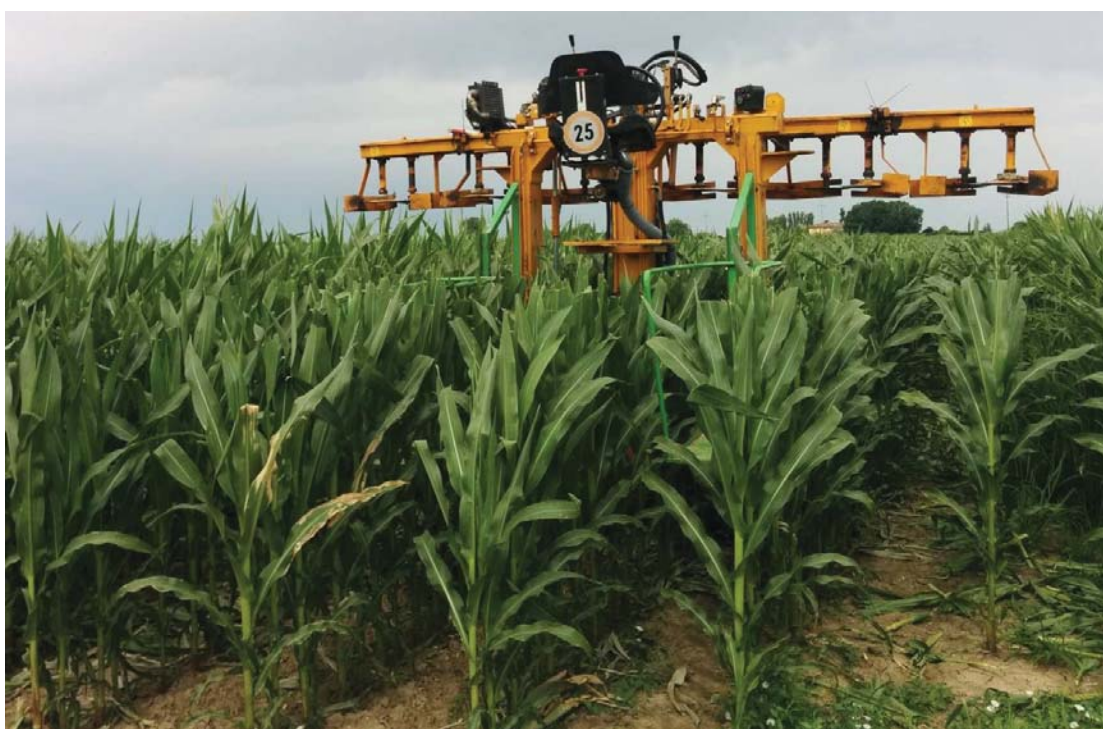
Figura 2: Emasculazione meccanica delle piante portaseme (foto a cura di Marco Venali).
