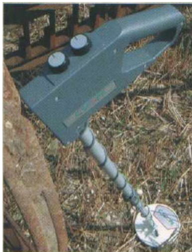
Fig. 2.11 Immagine del metal detector adottato per la ricerca dei picchetti interrati.
