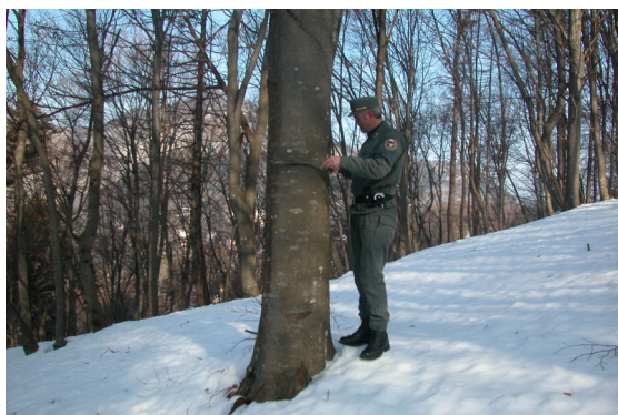
Fig. 2.2 Modalità corrette di impugnatura del cavalletto dendrometrico.
