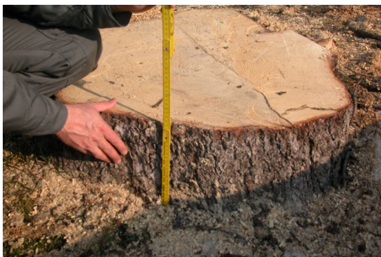
Fig. 2.3 Modalità corrette di posizionamento dei nastri di misura.
