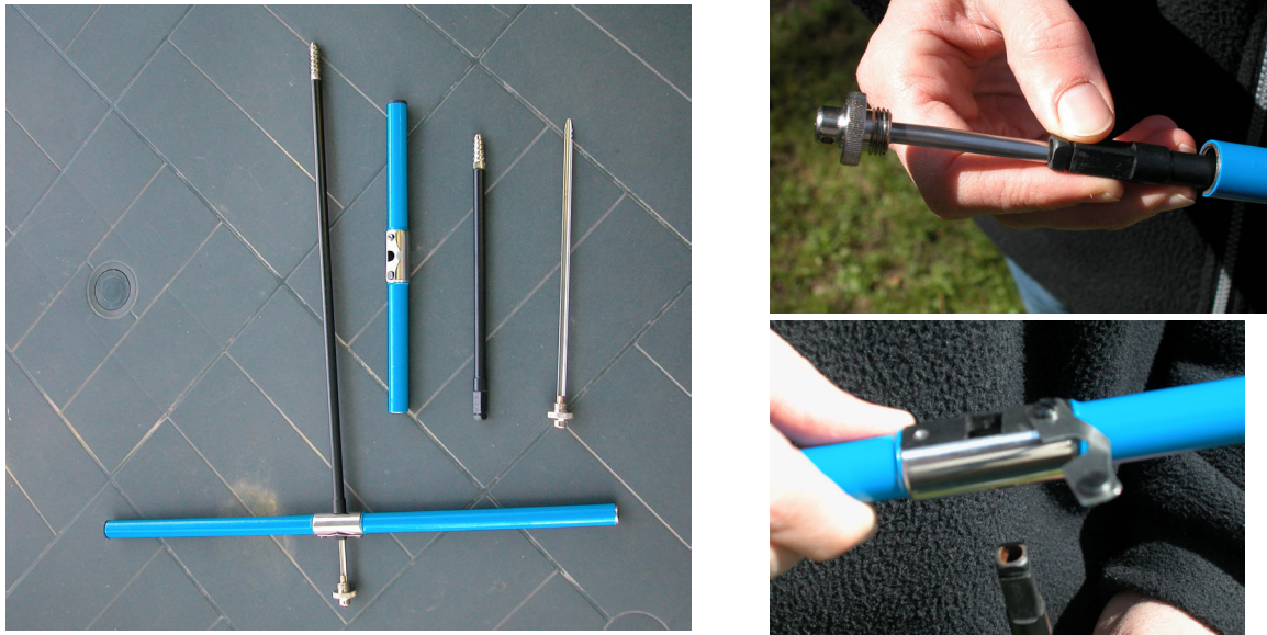
Fig. 2.9 Immagine del succhiello di Pressler, con dettagli delle componenti.
