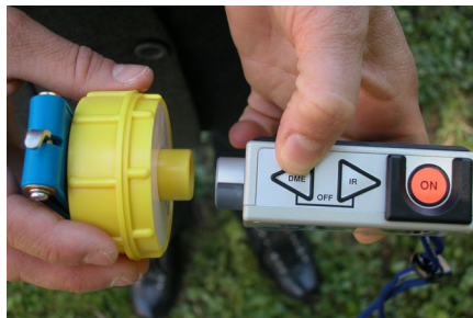
Fig. 2.7 Attivazione del transponder da parte del Vertex.
