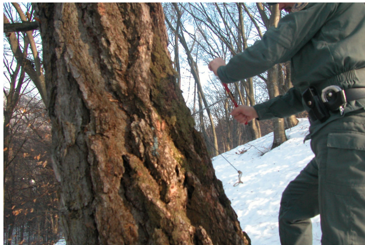
Fig. 2.10 Inserimento della trivella nel fusto per il prelievo della carotina.
