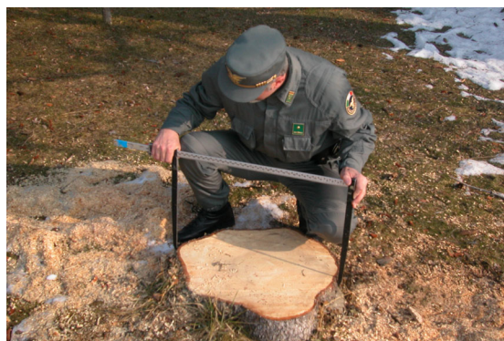
Fig. 2.2 Modalità corrette di impugnatura del cavalletto dendrometrico.
