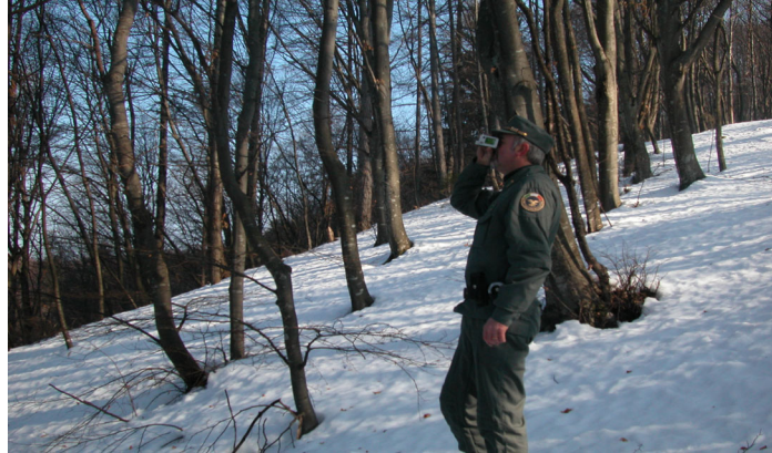
Fig. 2.8 Puntamento alla cima dell'albero per il rilievo dell'altezza.
