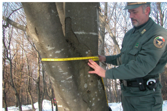
Fig. 2.3 Modalità corrette di posizionamento dei nastri di misura.
