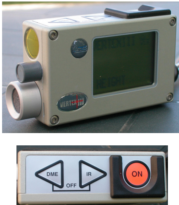
Fig. 2.4 Immagine dello strumento, con dettaglio dei pulsanti sulla faccia superiore.
