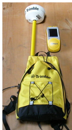
Figura 2.1 – Da sinistra a destra: il ricevitore GPS/palmare Trimble GEO-XT, il ricevitore GPS Trimble PRO-XR con zainetto, il datalogger palmare Intermec 700 che pilota il PRO-XR.
