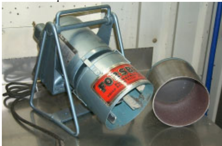
Scarificatore meccanico azionato elettricamente. Durante il funzionamento il cilindro rivestito con carta vetrata si inerte in quello contenente le pale (Fonte: Forsberg)
