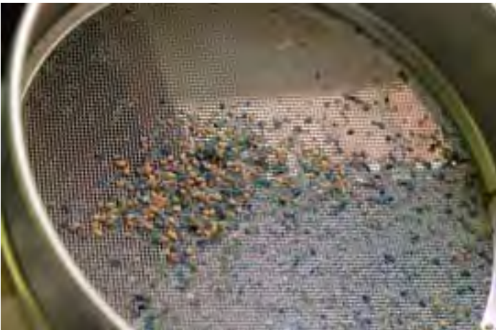
embrioni di orzo su setaccio (diam. 1 mm) per analisi della presenza di Ustilago nuda (torna)
