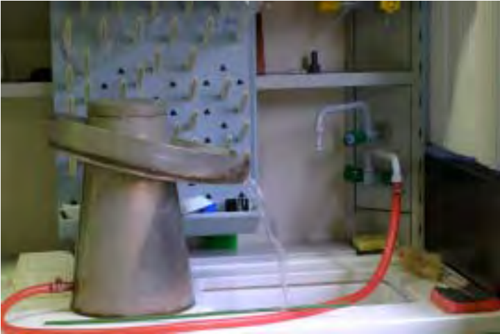
imbuto di Fenwick (modificato) per la separazione di embrioni di orzo (torna)
